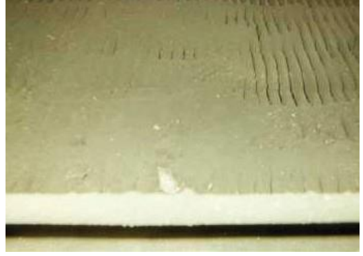
Sonik temizlemesiz bir aydan sonra ekonomizer kesiti.
