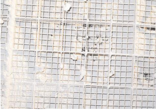
Sonik Temizlemesiz bir aydan sonra Seçili Katalitik İndirgeciyi (SCR) kesiti.
